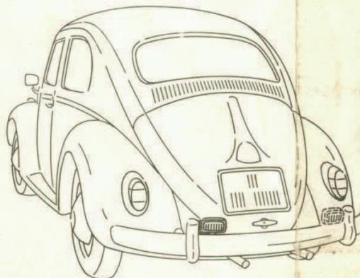
Bild 1 Ein oder zwei Rückfahrcheinwerfer LE/RA . .
